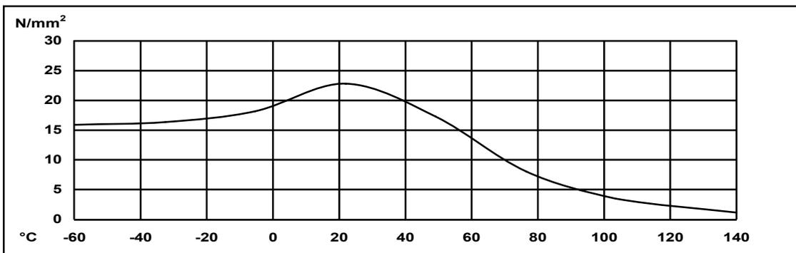
**其它典型性能** 固化: 25 °C下固化72小时，25 °C下测试，喷砂钢+喷砂钢
